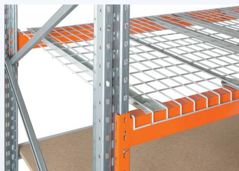
Conçu pour éviter la chute de produits à travers les niveaux et sécuriser les allées de passage ou les niveaux picking (Epsirack hybride). Dans certains cas ils peuvent assurer le stockage de vos produits non palettisés. Platelage fil Ø 5 mm, maille 50 x 100 mm, électrozingué. Capacité de charges max. : 800 kg/module. Livré en plusieurs modules.
