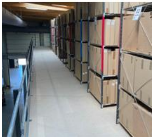
OMNIBASIC-stelling op Mezzaman-tussenvloer voor opslag.
